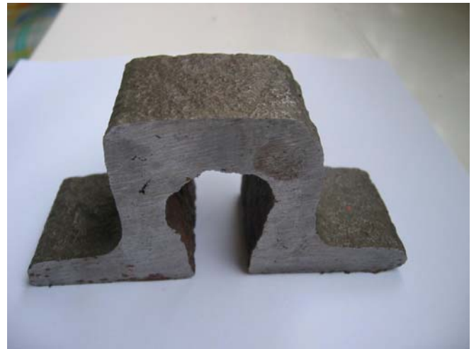
„Brückenschiene“ hergestellt in Gleiwitz (Schlesien) ca. 1845/48. Verwendet als Pferdebahnschiene im Tagebau Rüdersdorf.
